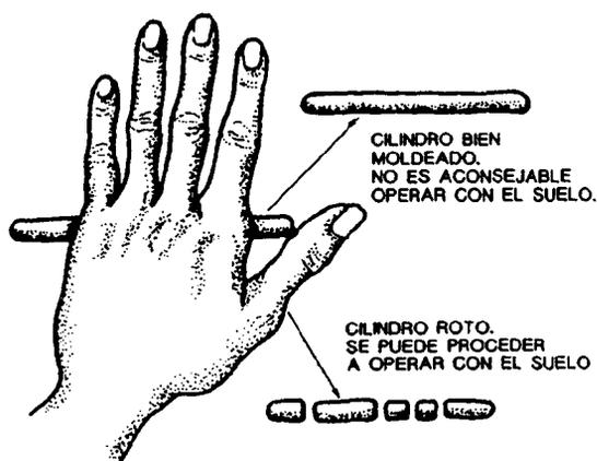
Figura 7.9 Prueba de campo para determinar la humedad del suelo.
