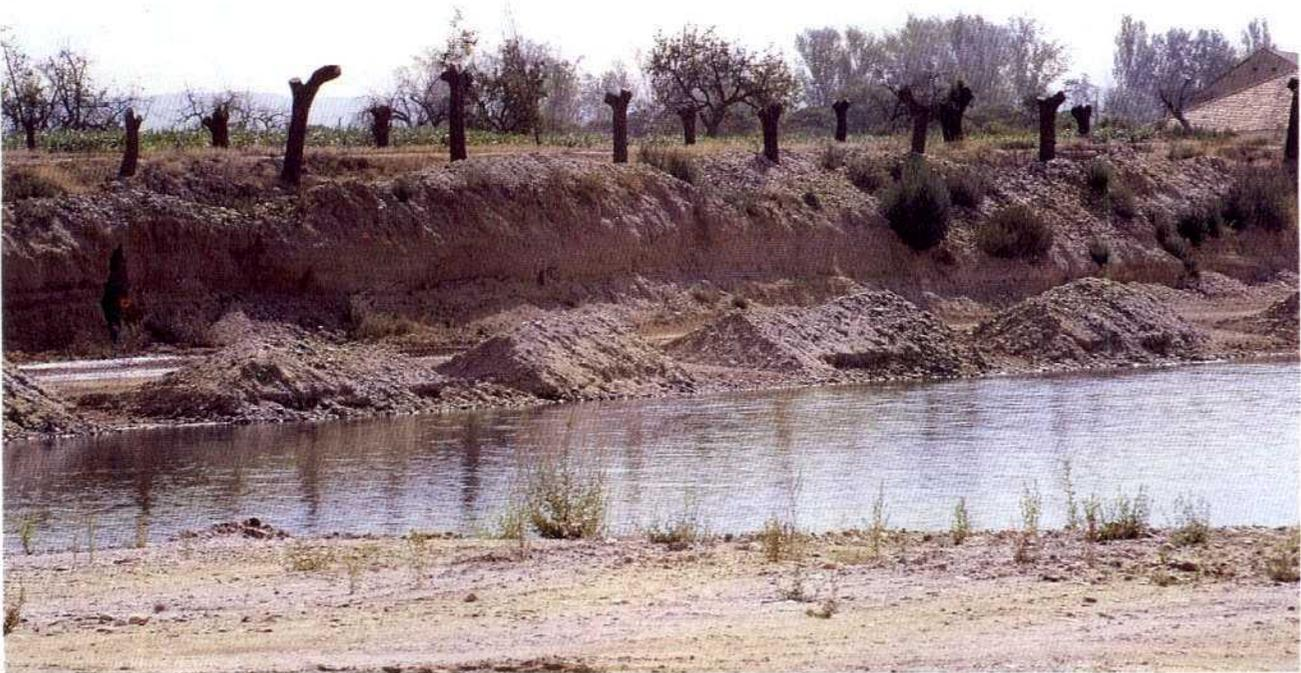
*Además de la eliminación directa de la vegetación que implica la apertura del hueco de extracción, en las explotaciones que se realizan por debajo del freático pueden ocasionarse daños indirectos e incluso la muerte de la vegetación freatofítica del entorno del área.*
