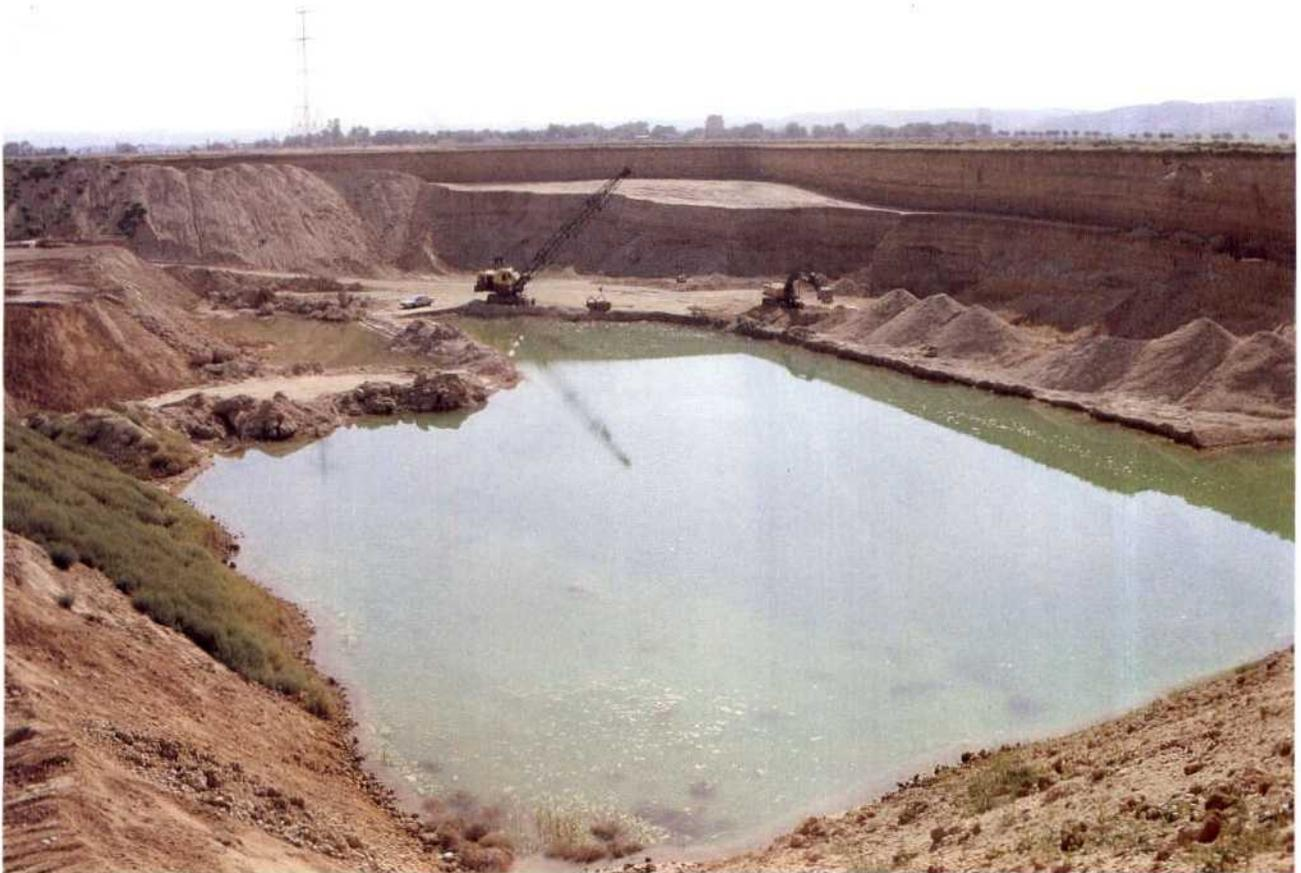
*Explotación en un solo banco de un paquete de gran potencia. La extracción del material se realiza bajo lámina de agua con una dragalina.*
