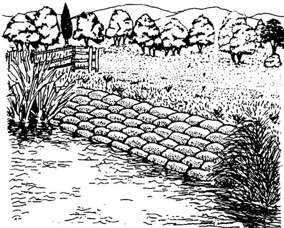
Figura 12.6. Revestimiento de un talud con sacos de hormigón.
